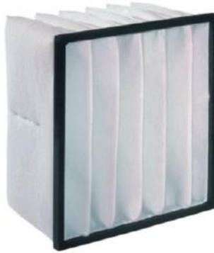
**I FILTRI A TASCHE MORBIDE IN FIBRA SINTETICA** sono caratterizzati da un'ampia gamma costruttiva, con differenti superfici filtranti determinate dal numero di tasche installate. Sebbene la perdita di carico finale di targa sia di 450 Pa si consiglia la sostituzione degli elementi tra 250 e 300 Pa. Una attenta gestione della caduta di pressione garantisce, infatti, un sensibile risparmio energetico.
